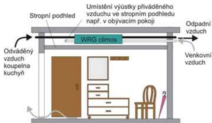
Obrázek 26 - Větrací jednotka s rekuperací tepla ve stropním podhledu na chodbě
